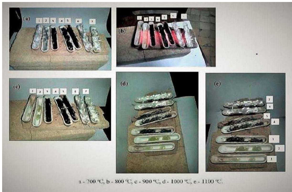
Рисунок 17 -Термообработка стекловолокон при температурах:
