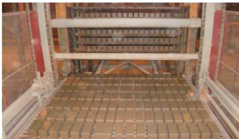
Рисунок 6- Загрузка на сушильную тележку
